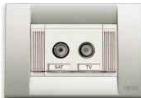
Presa coassiale TV-RD-SAT a due uscite (connettori maschio e femmina IEC 169-2) installata con supporto 2 moduli 16722.B e placca classica 3 moduli in metallo pressofuso colore champagne micalizzato
