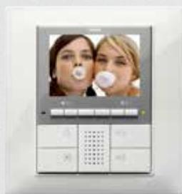
**By-me 控制单元** – 它是整个系统的中心。您可以通过它控制所有细节: 自动化设备, 报警器, 温度, 能源, 可视门禁系统。简单, 直观, 直接连接专用接口, 可以通过扩展自动化设备和报警器系统扩大整个系统。
