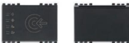
**19457** Lecteur de cartes à transponder pour l'installation à l'extérieur de la pièce, standard KNX, 2 sorties à relais NO 4 A 24 V~, 2 entrées, 12-24 V~ 50/60 Hz et 12-24 Vdc (TBTS) - 3 modules. Sans carte transponder. Profondeur: 37 mm
