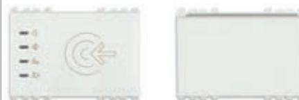
**19457.B** Lecteur de cartes à transponder pour l'installation à l'extérieur de la pièce, standard KNX, 2 sorties à relais NO 4 A 24 V~, 2 entrées, 12-24 V~ 50/60 Hz et 12-24 Vdc (TBTS) - 3 modules. Sans carte transponder. Profondeur: 37 mm
