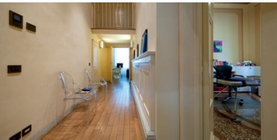
“ L'edificio è stato interamente predisposto alla domotica facendo passare il cavo BUS nelle stesse canaline in cui passano i cavi elettrici, poi coperte da uno zoccolo in legno, facilmente smontabile in caso di necessità
