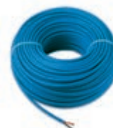
01840.E.B Cavo per diffusione sonora sistema Bus By-me, 2x0,50 mm 2 , con guaina in LSZH, Classe CPR Eca, idoneo per installazione con cavi energia di I Categoria (U 0 = 400 V), blu - 100 m
