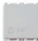
14183.SL Pulsante per chiamata d'emergenza, 2 relè NO 5 A 250 V~, 12 V~ o 12-24 Vdc - 2 moduli. Prof.tà: 36 mm
