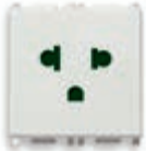
14248 SICURY 2P+T 16 A, euroamericano polarizzato - 2 moduli. Prof.tà: 25,5 mm
