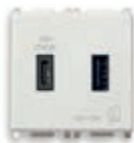
14295.AC 5 V 3 A, USB A+C per totale 3 A, 120-240 V~ 50/60 Hz - 2 moduli. Prof.tà: 29 mm
