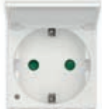
14208.C SICURY 2P+T 16 A, standard tedesco, con coperchio - 2 moduli. Prof.tà: 29,6 mm
