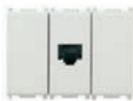
14505.AB Modulo relè con presa RJ45 per perella 2luce+2aux, collegamento verso un modulo 8IN/8OUT o un display Call-way, 4 uscite a relè 24 V NO, materiale antibatterico - 3 moduli. Profondità: 29,5 mm
