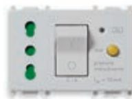
14283.SL Bpresa 16 A P17/11 250 V~, 1P+N C 16 - 3 moduli. Prof.tà: 38,7 mm
