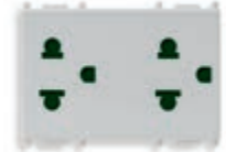
14249.SL Due prese SICURY 2P+T 16 A, euroamericano polarizzato - 3 moduli. Prof.tà: 23,5 mm
