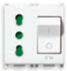
14273 Bpresa 16 A P17/11 250 V~, 1P+N C 16 - 2 moduli. Prof.tà: 38,7 mm
