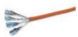
■ 03086.E Cavo Cat. 6A S/FTP, schermato, 4 coppie, 23 AWG, con guaina LSZH, Classe CPR Eca, idoneo per installazione con cavi energia di I Categoria (U0 = 400 V), arancione - 500 m
