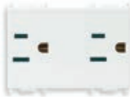
14243 Due SICURY 2P+T 15 A, standard USA e Arabia - 3 moduli. Prof.tà: 25 mm
