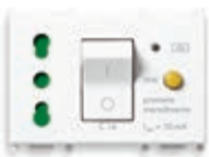
14283 Bpresa 16 A P17/11 250 V~, 1P+N C 16 - 3 moduli. Prof.tà: 38,7 mm
