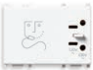
14290 230 V~ 50/60 Hz, con trasformatore di isolamento 20 VA, uscite 230 V~ e 120 V~ - 3 moduli. Prof.tà: 41 mm
