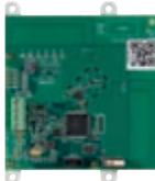
▲03832 Kartica primopredajnika, spajanje na centralu putem sabirnice, 2 antene za vodoravnu polarizaciju i okomitu prema načelu antenske raznolikosti
