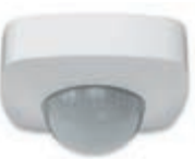
02690 Svjetlosna, žarulje sa žarnom niti 2000 W, CFL 10-1000 W, LED 100 W, 220-240 V~ 50/60 Hz, stropna montaža
