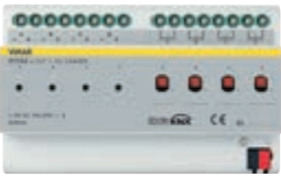
01550.1 Variateur 4 sorties à relais NO 16 A 250 V~, 4 sorties 1-10 V, poussoirs pour commande locale, standard KNX Secure, installation sur rail DIN (60715 TH35), occupe 8 modules de 17,5 mm
