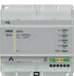
01415 Passerelle IoT pour l'intégration du système portier-vidéo Due Fili Plus au réseau IP/LAN, Cloud et Appli pour smartphone, tablette, PC ou écran tactile de supervision, installation sur rail DIN (60715 TH35), occupe 6 modules de 17,5 mm
