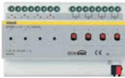
01550 Variateur 4 sorties à relais NO 16 A 250 V~, 4 sorties 0/1-10 V, poussoirs pour commande locale, standard KNX, 8 modules de 17,5 mm
