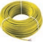
01840.C Câble pour système Bus By-me, 2x0,50 mm², avec gaine en LSZH, Classe CPR Cca s1b d1 a1, compatible pour l'installation de câbles d'énergie de catégorie I (U0 = 400 V), jaune - 100 m
