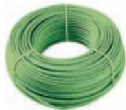
01890.C Câble pour systèmes KNX, 2x2x0,8 mm, avec gaine en LSZH, Classe CPR Cca s1b d1 a1, conforme au standard KNX, compatible pour l'installation de câbles d'énergie de catégorie I (U0 = 400 V), vert - 100 m
