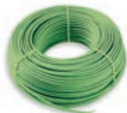
01890.E Câble pour systèmes KNX, 2x2x0,8 mm, avec gaine en LSZH, Classe CPR Eca, conforme au standard KNX, compatible pour l'installation de câbles d'énergie de catégorie I (U0 = 400 V), vert - 100 m
