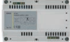
01401 Alimentation avec sortie 29 Vcc, 1280 mA sortie, 120-230 V~ 50/60 Hz, installation sur rail DIN (60715 TH35), occupe 8 modules de 17,5 mm
