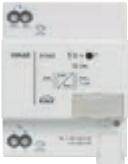
01542 Passerelle DALI KNX, 1 canal pour 64 lampes à regrouper en 16 groupes, 4 modules de 17,5 mm
