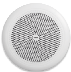
01906 Diffusore passivo sonoro IP55 8 Ω 30 W, installazione su pareti leggere e controsoffitto. Prof.tà: 70 mm
