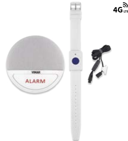
03890 Dispositivo vivavoce di telesoccorso per chiamata via rete cellulare LTE di numeri predefiniti. La chiamata vivavoce viene avviata premendo il pulsante "Alarm" o tramite il pulsante dell'accessorio bracciale/pendaglio. Il dispositivo consente anche la ricezione di chiamate esterne con risposta automatica
